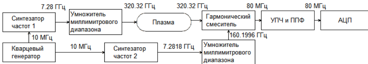
Рис. 1 Схема канала интерферометра 320 ГГц для Т-15
