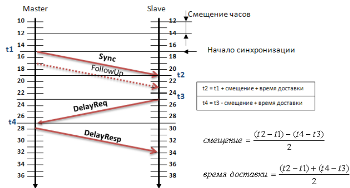
Рис.1. Процесс обмена синхропосылками для корректировки сетевого времени
