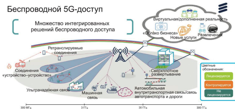
Рис. 2 – Сценарий беспроводного доступа к 5G-сети
