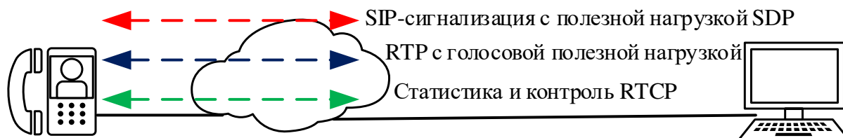
Рисунок 1. Протоколы для передачи голосового вызова VoIP между двумя терминалами.
