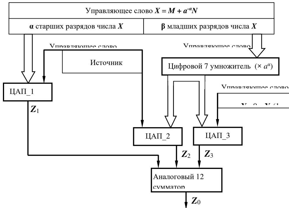
Рис. 4. Второй способ нониусного цифроаналогового преобразования
