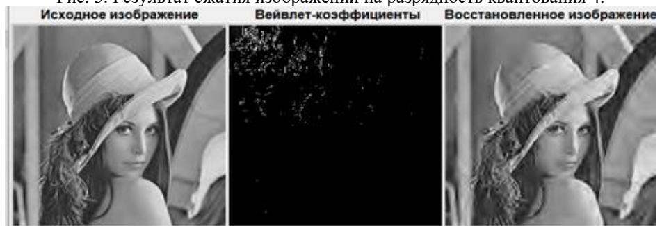
Рис. 6. Результат сжатия изображений на разрядность квантования 5.
