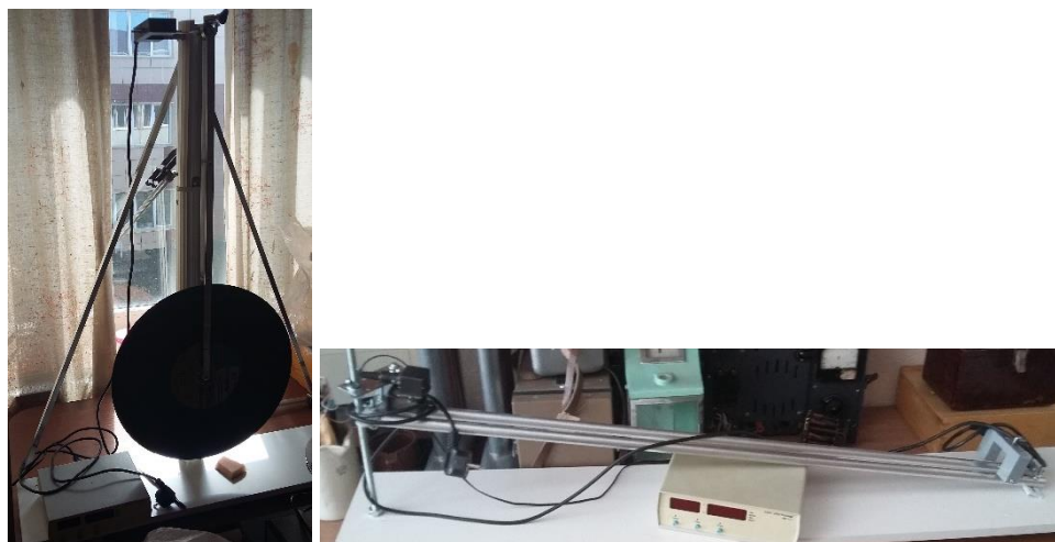
Рис. 5. Установки для измерения момента инерции симметричных тел. Слева установка на основе физического маятника, справа – установка со скатывающимся шариком по направляющим. Обе установки оснащены самодельными датчиками и системами автоматизации измерений.
