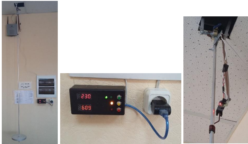
Рис. 3. Установка "Комбинированный маятник" для изучения затухающих колебаний, измерения ускорения свободного падения. Установка оснащена самодельным многофункциональным контроллером.
