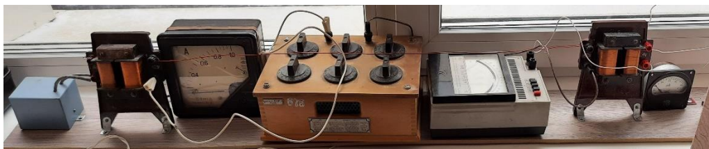
Рис. 1. Модель высоковольтной линии электропередач. Демонстрируется и изучается закон Джоули-Ленца, производятся измерения КПД ЛЭП с технологией повышения напряжения и без нее.
