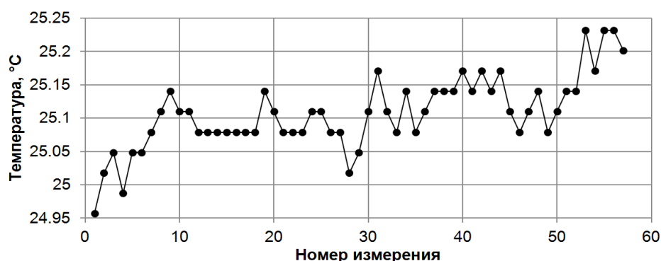
Рис. 2. Температура воздуха в окрестностях осциллографа в период эксперимента
