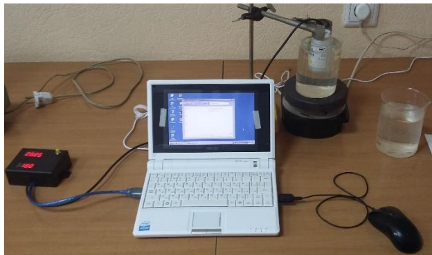
Рис. 4. Установка для изучения фазовых переходов и переохлажденного состояния жидкостей. Установка оснащена самодельным контроллером, позволяющим снимать показания о состоянии фаз как в ручном режиме, так и помощью специализированного ПО на компьютере.
