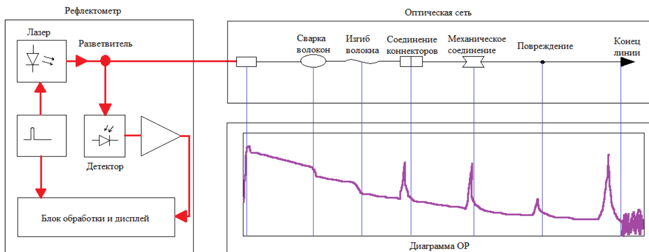
Рис. 1. Схема подключения оптического рефлектометра
