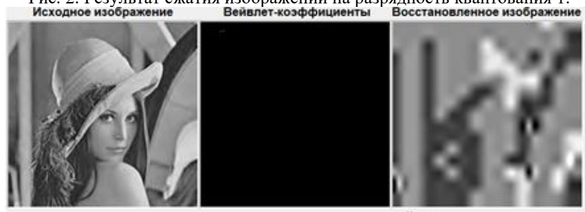
Рис. 3. Результат сжатия изображений на разрядность квантования 2.
