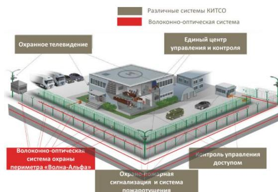
Рисунок 9 – Волоконно-оптическая распределенная виброакустическая система
