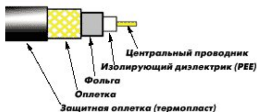
Рисунок 1– устройство коаксиального кабеля
