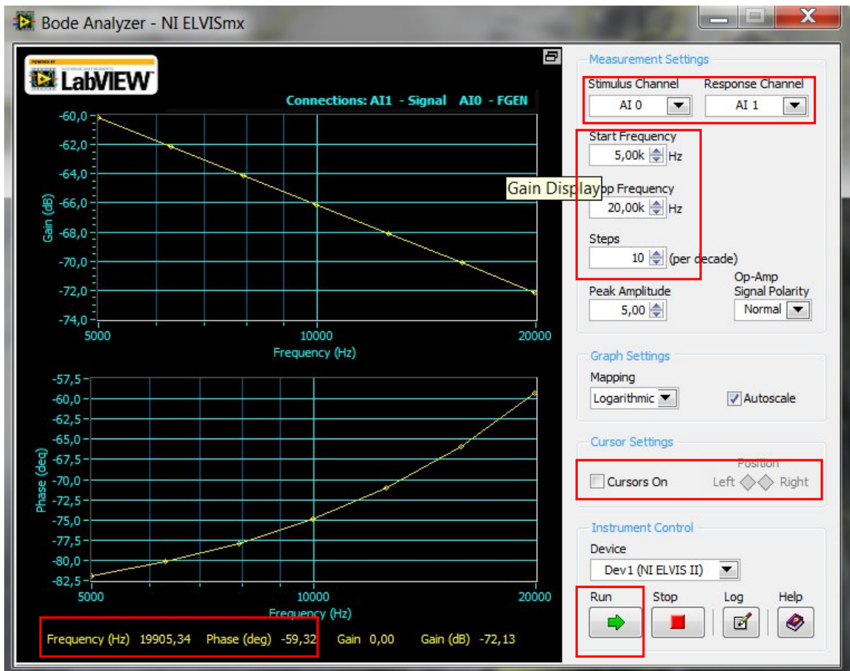
Рисунок 3 – Настройка и работа анализатора АЧХ и ФЧХ.
