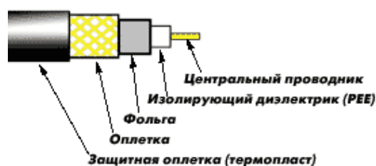
Рисунок 1– устройство коаксиального кабеля
