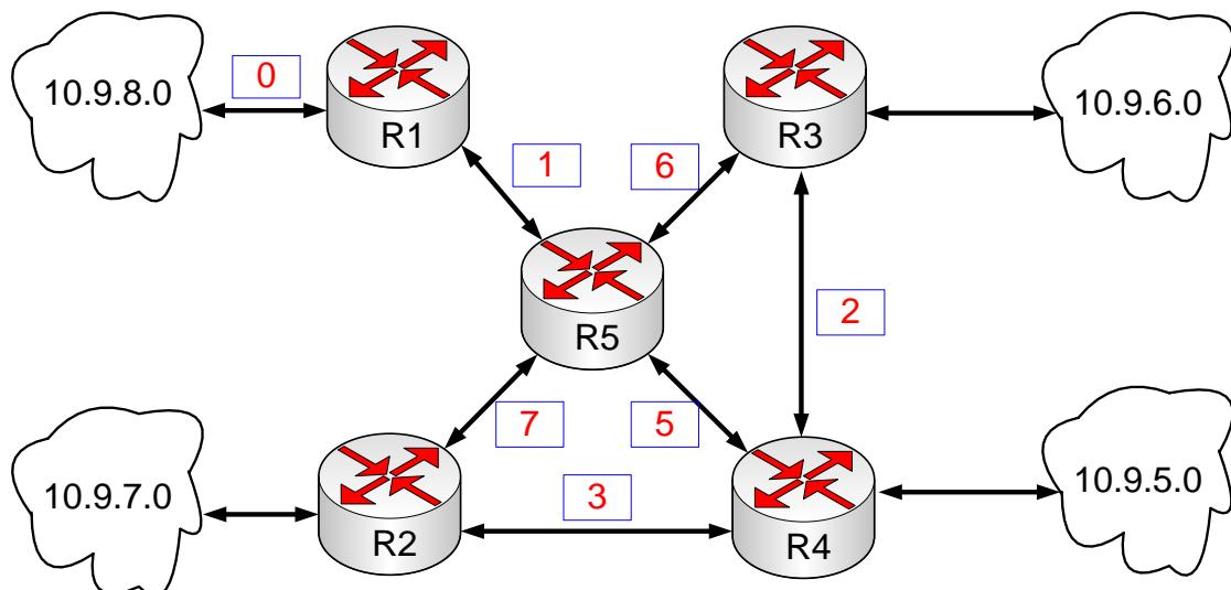
Если не учитывать возможное разделение трафика по требуемому качеству обслуживания, то при выделении FEC рассматривается только пара IP-адресов источника и приёмника. Тогда можно выделить следующие FEC для представленных маршрутизаторов:
