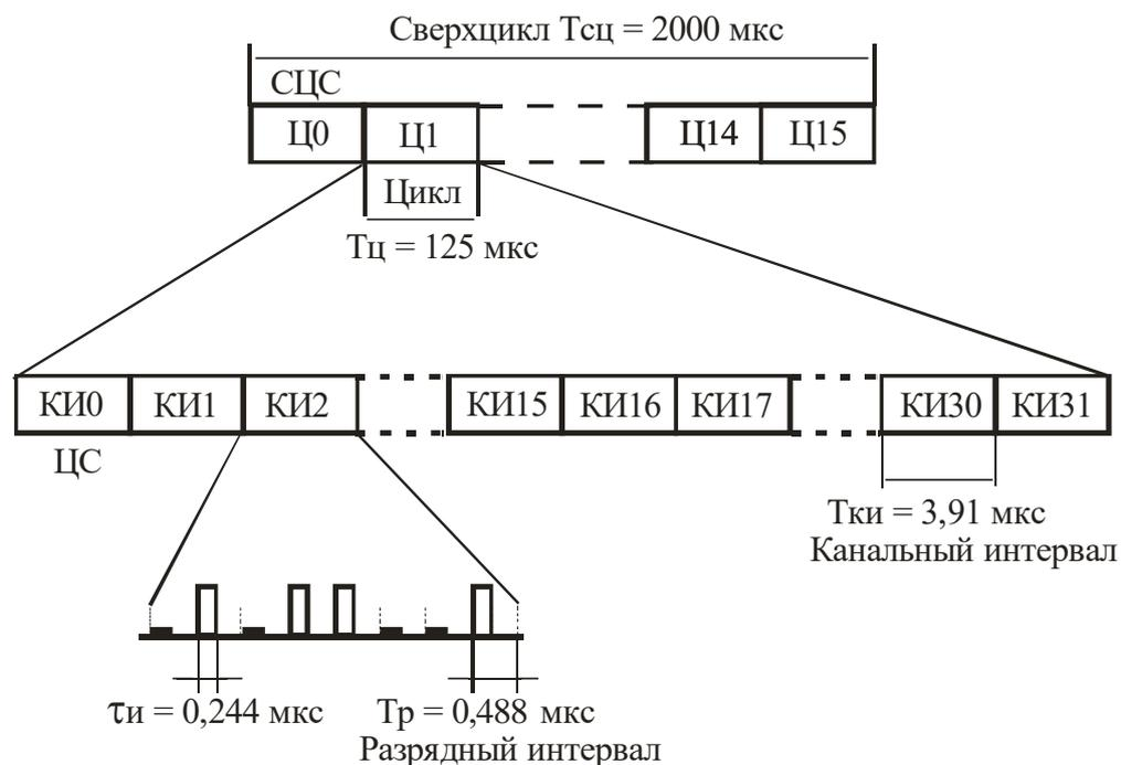
Рисунок 3 – Диаграмма временного сверхцикла, цикла, канального интервала
