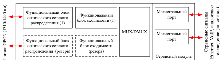
Рисунок 7 – Функциональная блок-схема ONU сети XGPON
