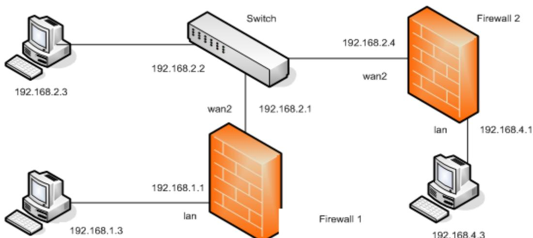
Рисунок 5 - Схема экспериментальной сети
